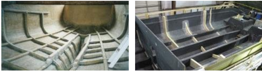
Gambar 3. Konstruksi Lambung Speedboat PSDKP
